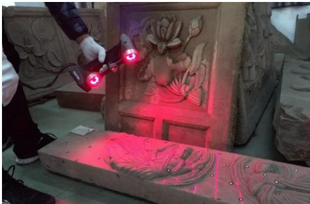
图 8 手持式三维扫描仪采集文物三维数据
